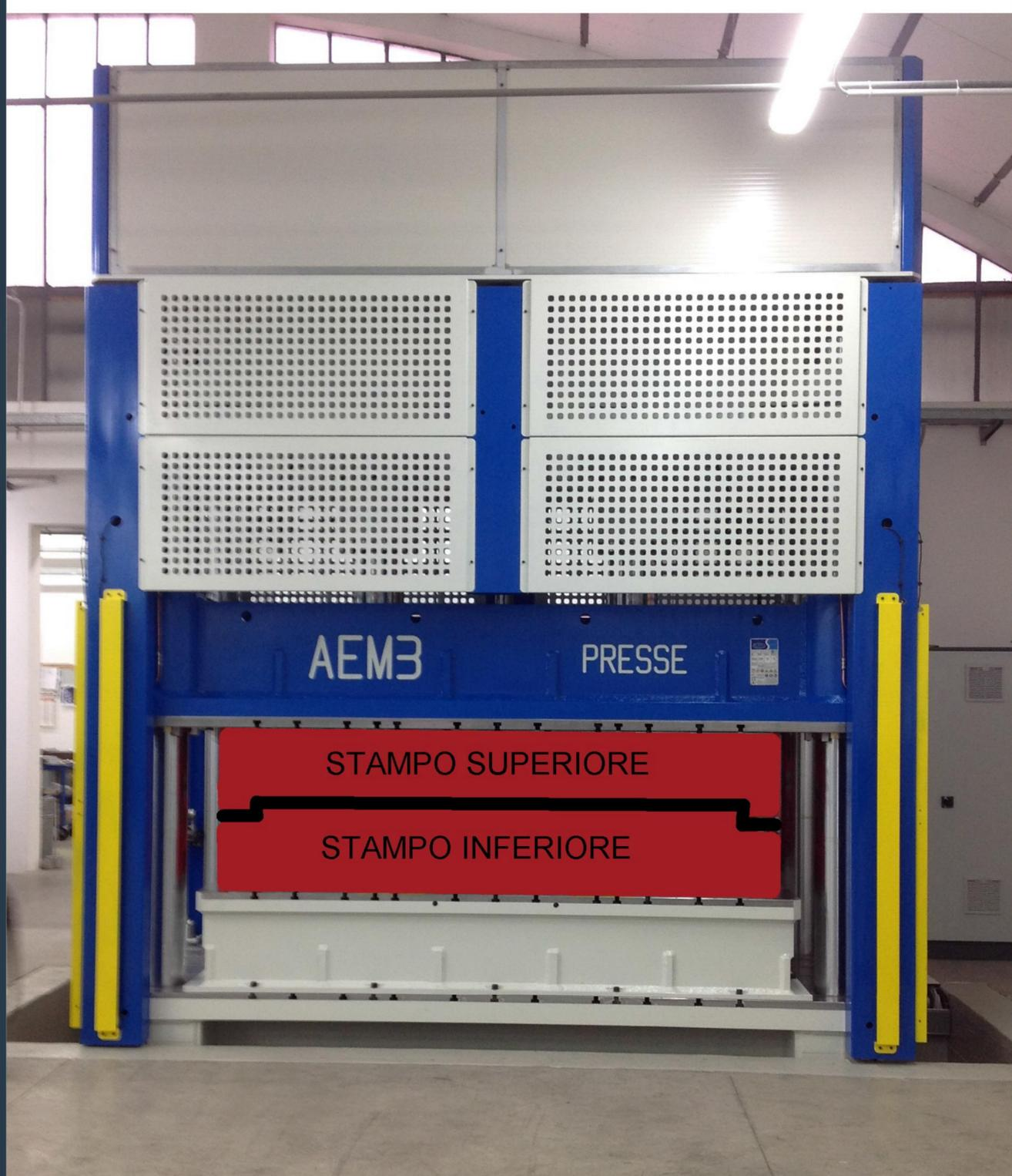
La luce verticale della pressa è 2000mm, la corsa del cilindro è 1200mm (per esigenze di altezza massima pressa).
