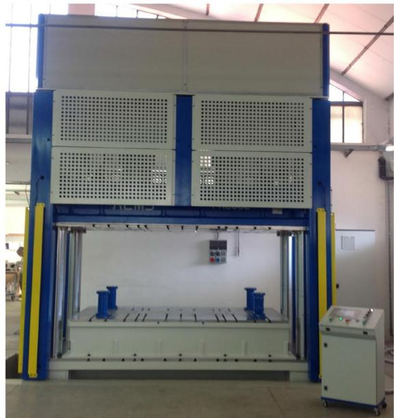
Barriere fotoelettriche di protezione sui 4 lati pressa che facilitano le operazioni di controllo e manutenzione stampo in tutti i lati.
