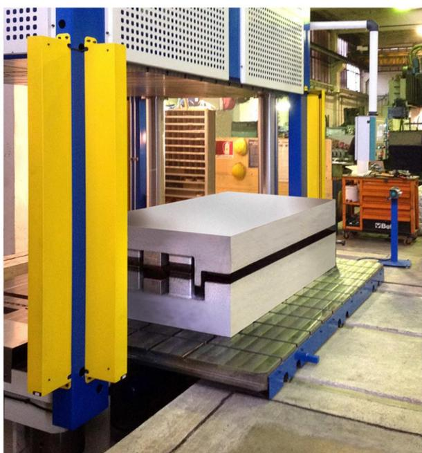
Pressa completa di barriere fotoelettriche
