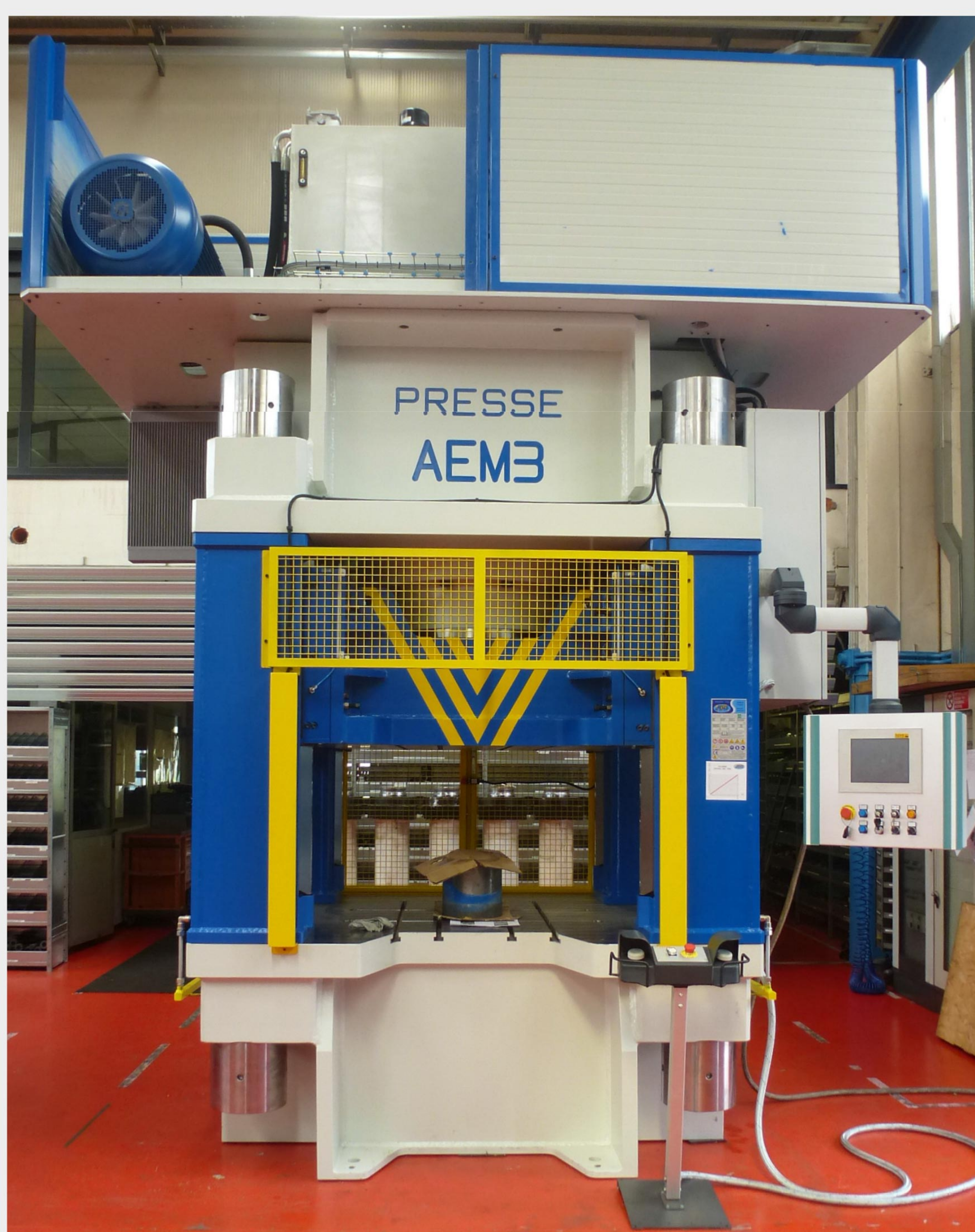
Potenza 800Tonn per forgiatura Luce tra le spalle fronte pressa 1300 mm Dimensione verticale tra i piani aperti 800 mm Corsa cilindro 600 mm.
