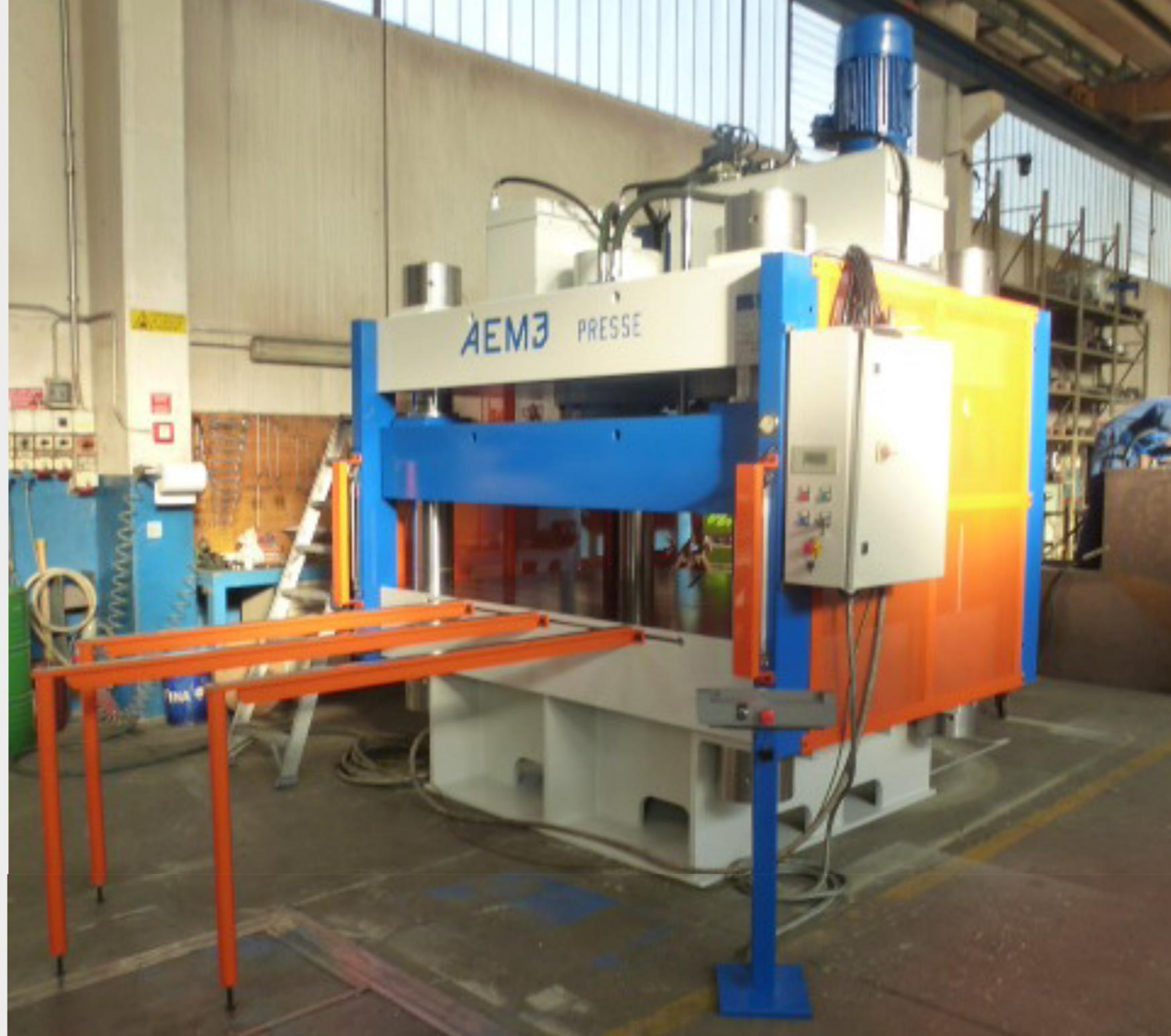
Pressa 800 Tonn per produzione guarnizioni speciali Dimensione del piano 2000*2000mm
