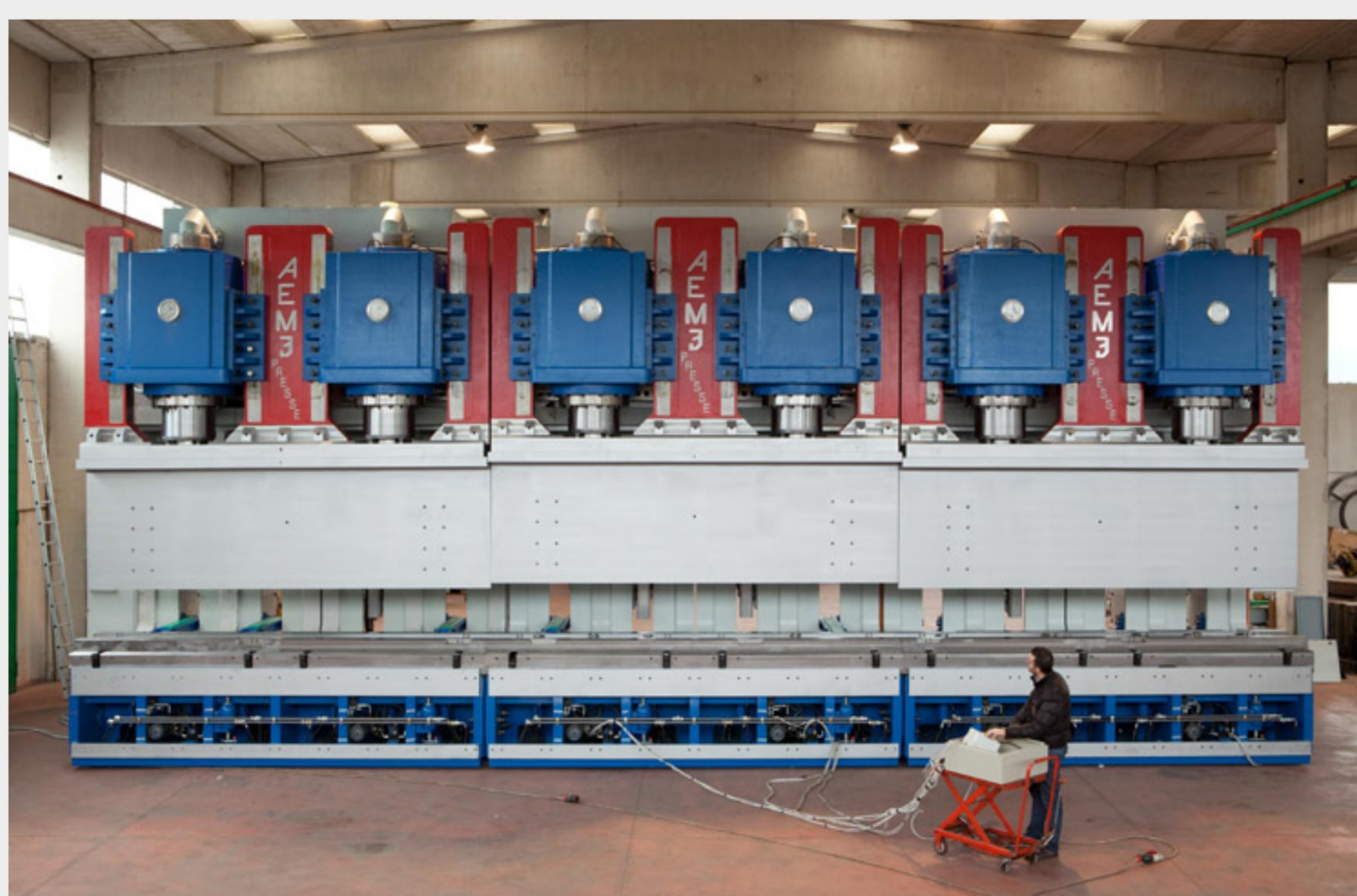
Pressa 800 Tonn per produzione guarnizioni speciali Dimensione del piano 2000*2000mm
